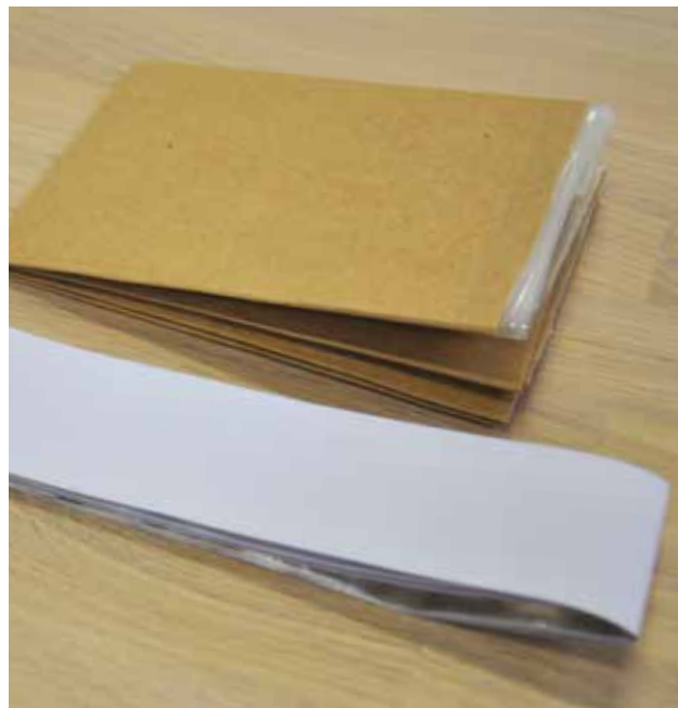
Alutape og fuktsperre.
